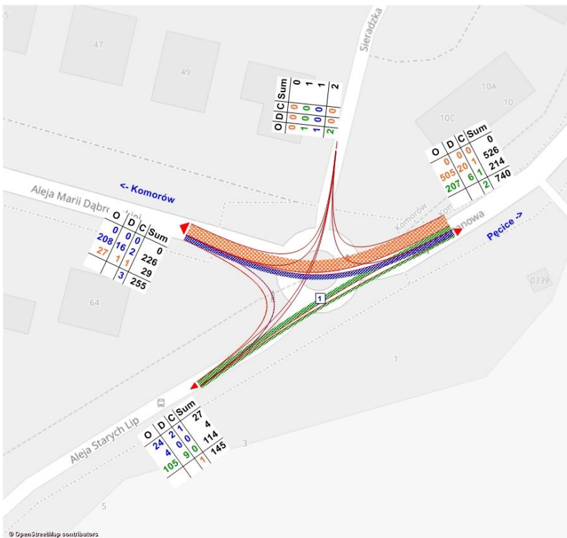
Rysunek 11 Natężenie ruchu w szczycie popołudniowym (16-17) na skrzyżowaniu Al. Kasztanowej, Al. Marii Dąbrowskiej, ul. Starych Lip i ul. Sieradzkiej [poj./godz.]
