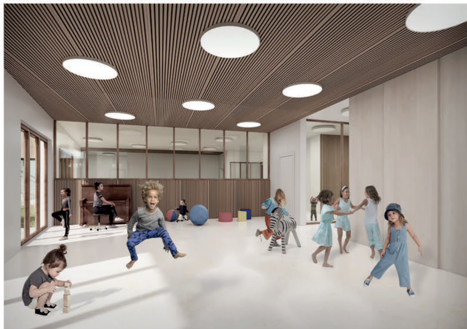
sala od rytmiki z mobilnym połączeniem z salą rekreacji - elementy drewnianego wykończenia pełnią rolę ustrojów akustycznych
